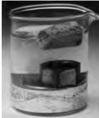
شکل موادی که چگالی آنها از چگالی آب کمتر است، روی آب شناور می‌مانند.
