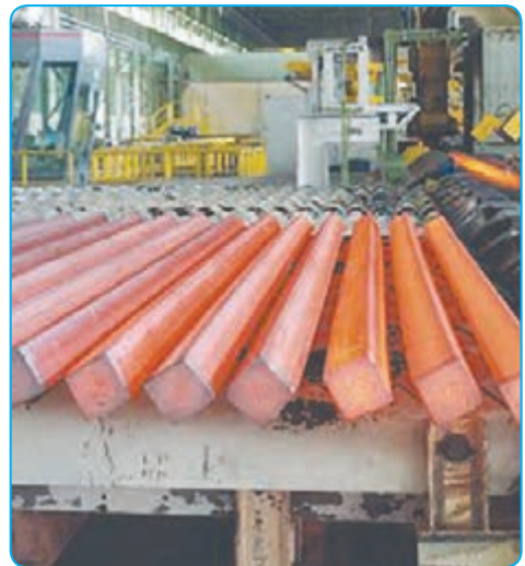
آهن در دمای بالا گداخته می‌شود
