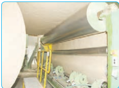
غلتک آهنی برای صاف کردن خمیر کاغذ
